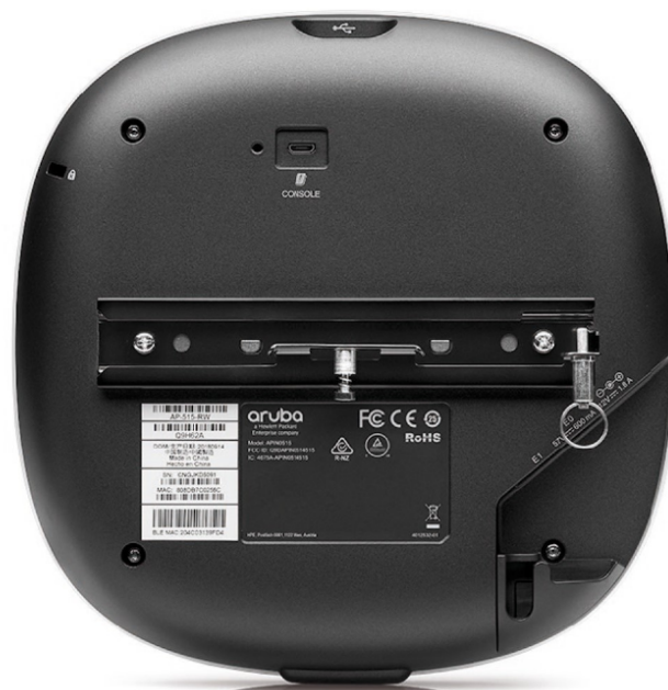
Sa zadnje strane je priključak za konzolu, dva RJ45 priključka za E0 i E1 te konektor za napajanje
