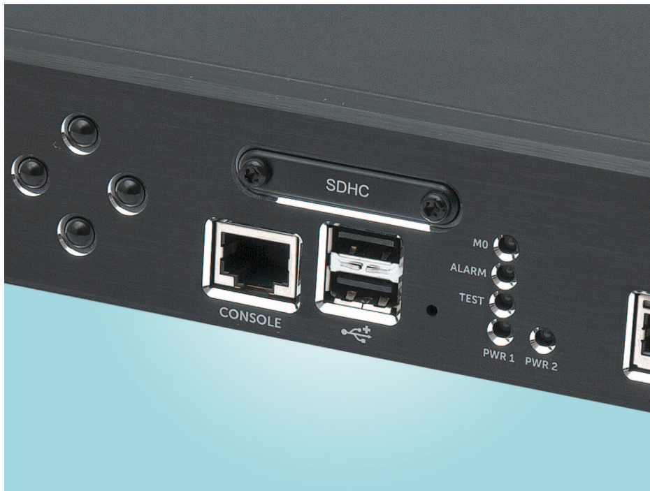
RJ45 serijski port koristi se za spajanje konzole, a dva USB porta namijenjena su spajanju modema (3G/4G/analogni)
