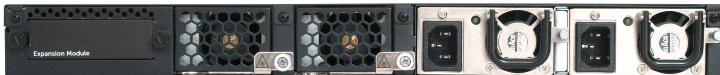
Redundantna napajanja i ventilatori lako se mogu promijeniti u slučaju kvara
